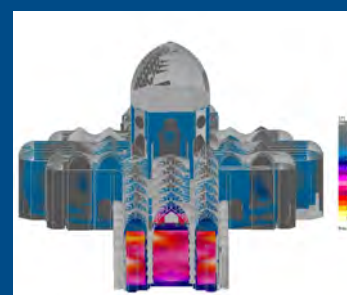
EASE-Simulation: STI-Index-Vorhersage mit zwei Ascolto LH6425 über dem Hörbereich (Kirchenschiff)
