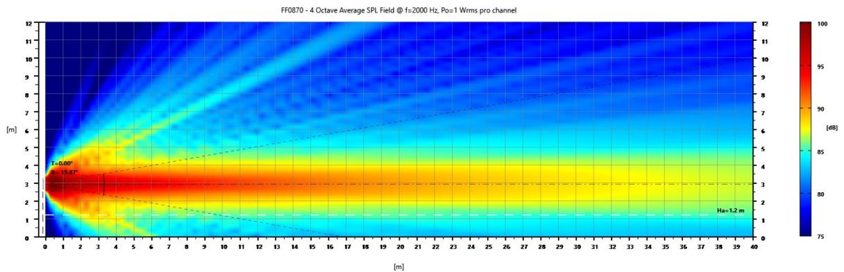
FF0870 – Vertikales Strahlmuster bei 2000 Hz, 4 Oktaven Durchschnitt
