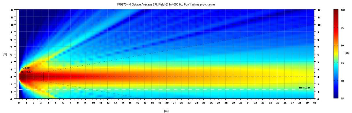
FF0870 – Vertikales Strahlmuster bei 4000 Hz, 4 Octaves Durchschnitt
