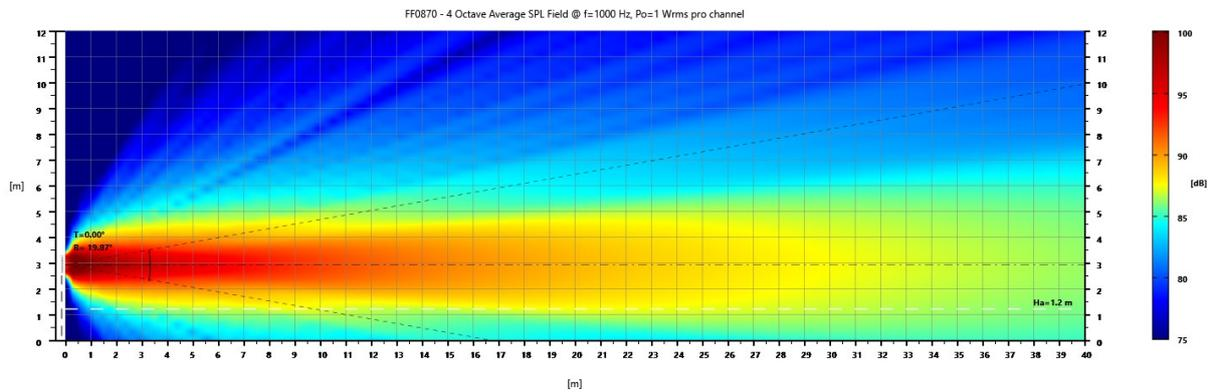
FF0870 – Vertikales Strahlmuster bei 1000 Hz, 4 Oktaven Durchschnitt
