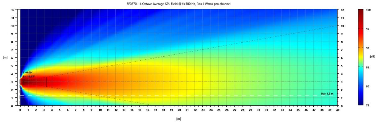
FF0870 – Vertikales Strahlmuster bei 500 Hz, 4 Oktaven Durchschnitt
