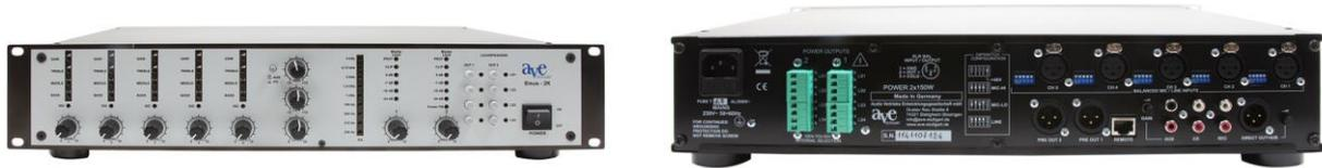
Das AVE-Modell Sinus – 2K ist ein Mischverstärker mit fünf Mikrofon/Line-Eingängen und einem umschaltbaren CD/AUX-Eingang. Jeder Mikrofon/Line-Eingang ist mit einem GAIN-Regler, einem 3-Band-Equalizer und einer Lautstärke- und Betriebsanzeige ausgestattet. Der CD/AUX-Eingang verfügt über einen separaten Höhen- und Tiefenregler. Ein grafischer 9-Band-Equalizer wirkt nur auf die Eingänge 1 – 5.
